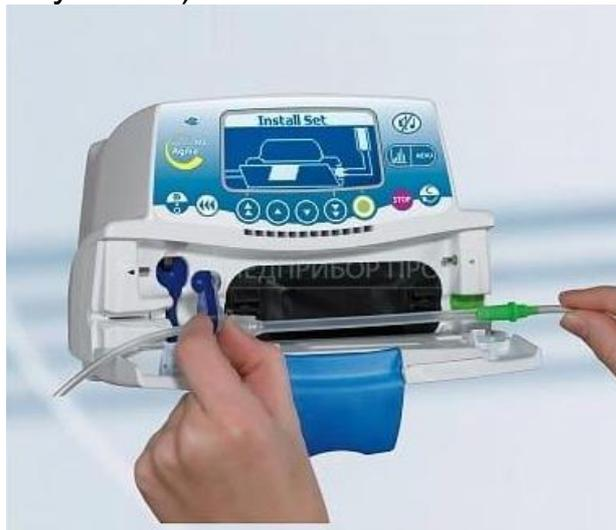
Рисунок 11. Крепление силиконовой вставки системы в инфузомате.
